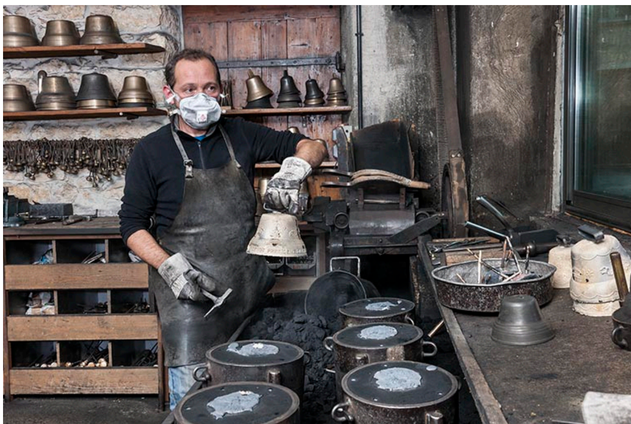
Démoulage. Extraction de la cloche (5).
