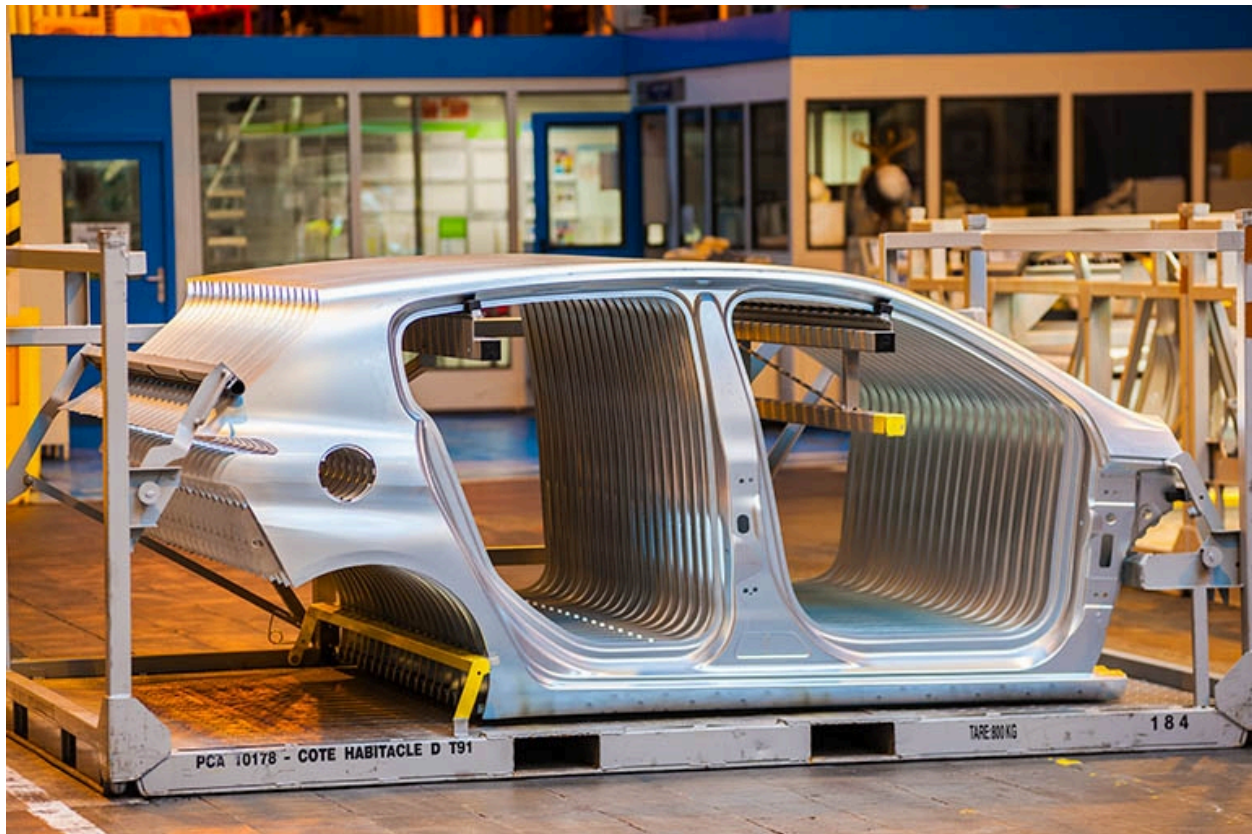
Atelier d'emboutissage. Côtés de caisse en sortie de presse.
