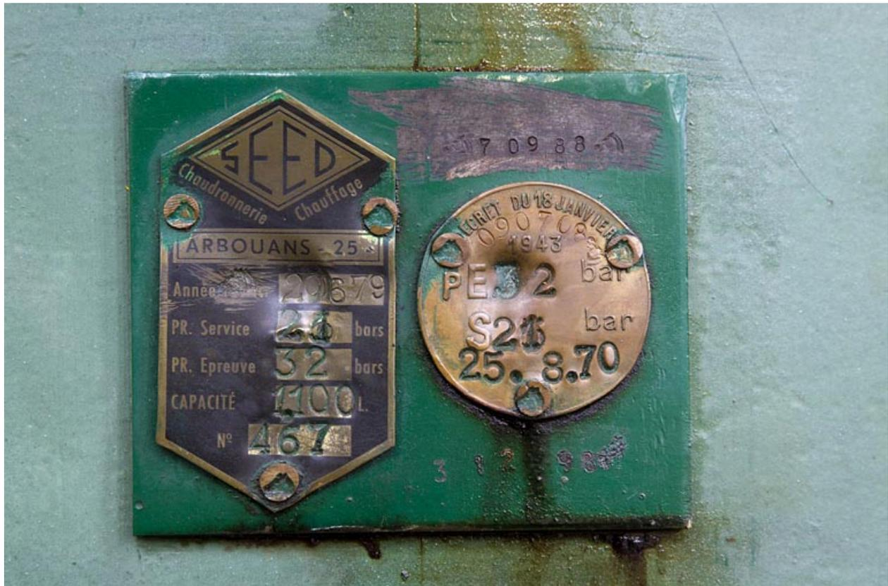
Réservoir d'air comprimé. Plaque d'épreuve.
