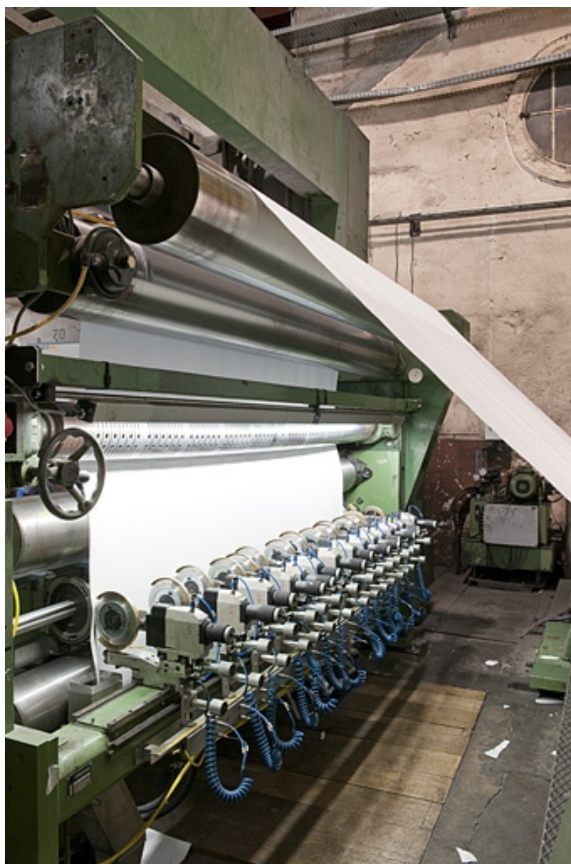
Têtes de découpage à l'extrémité de la machine à papier.
