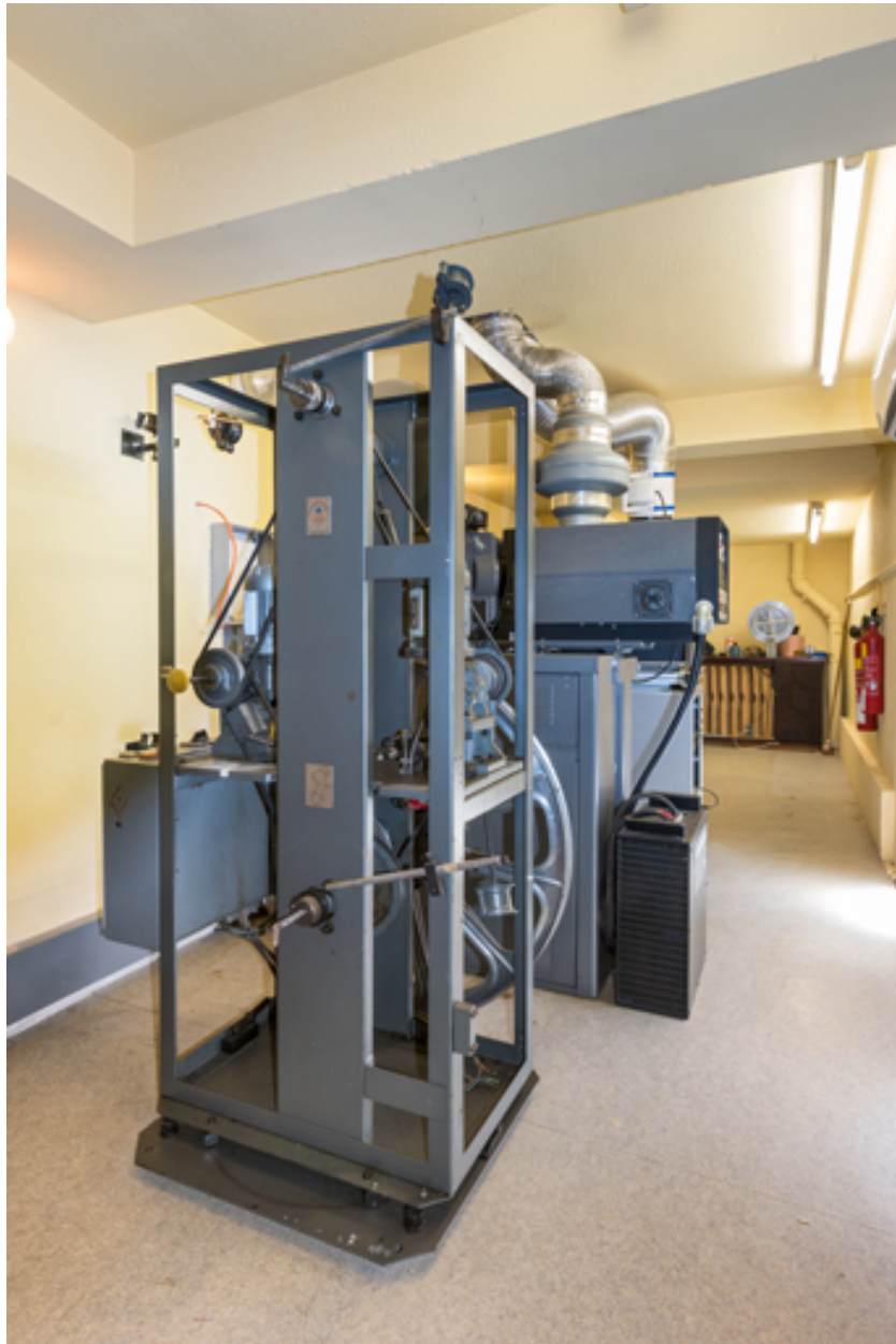
Ancienne cabine de projectionniste (enrouleur de films Cinemeccanica et projecteur Strong Simplex 35 Millenium).
