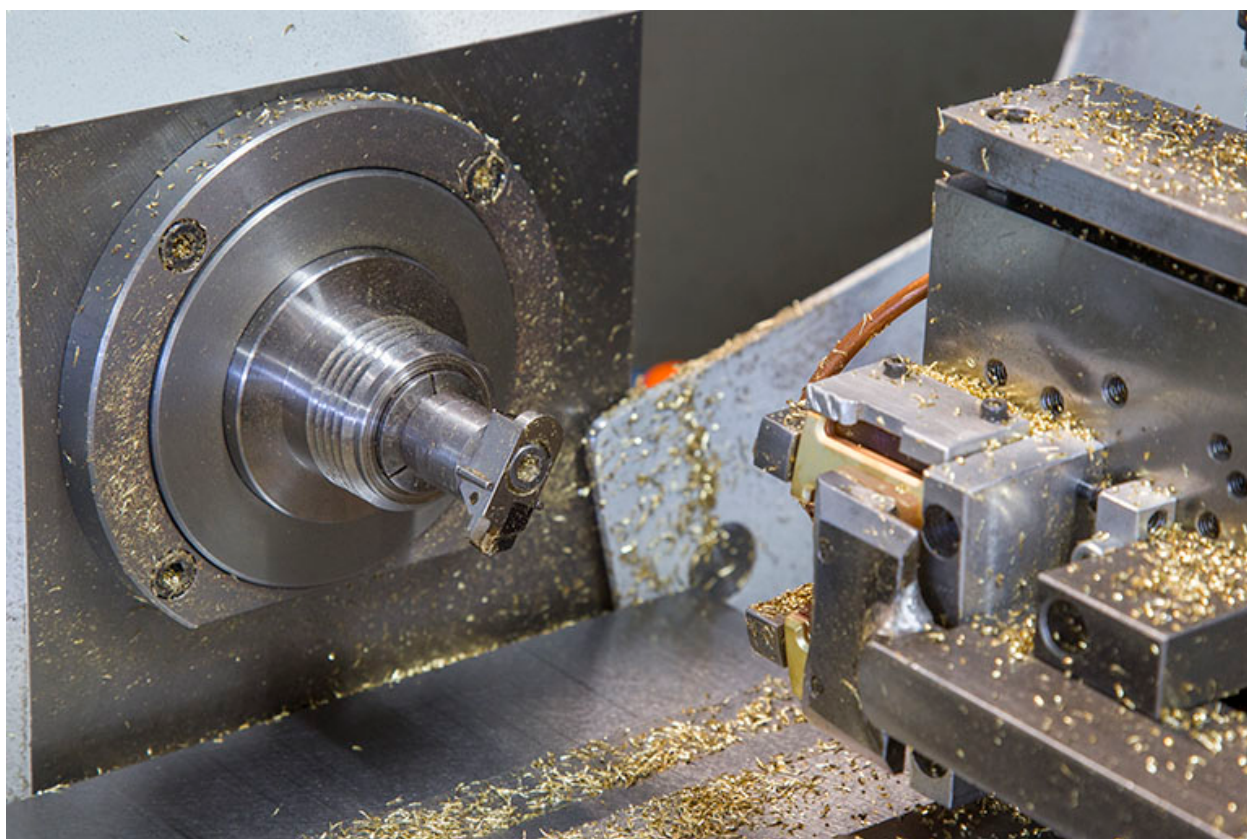
Tour à diamanter : espace d'usinage.
