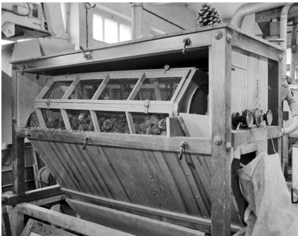
Détail du tambour chargé de cônes.
