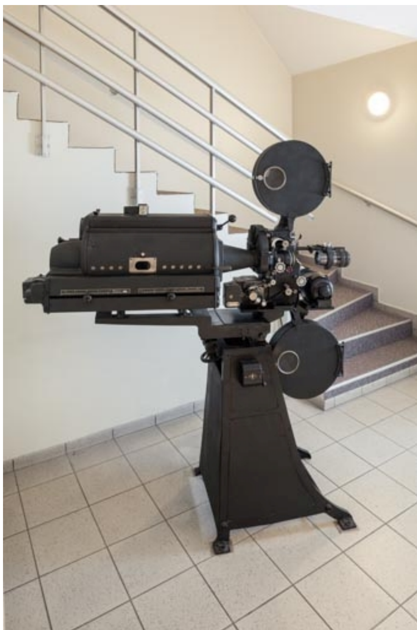
Projecteur Etoile Film (Lyon) équipé d'un système sonore Appareils Sonores "Universel" (Paris), présenté dans le hall d'entrée.
