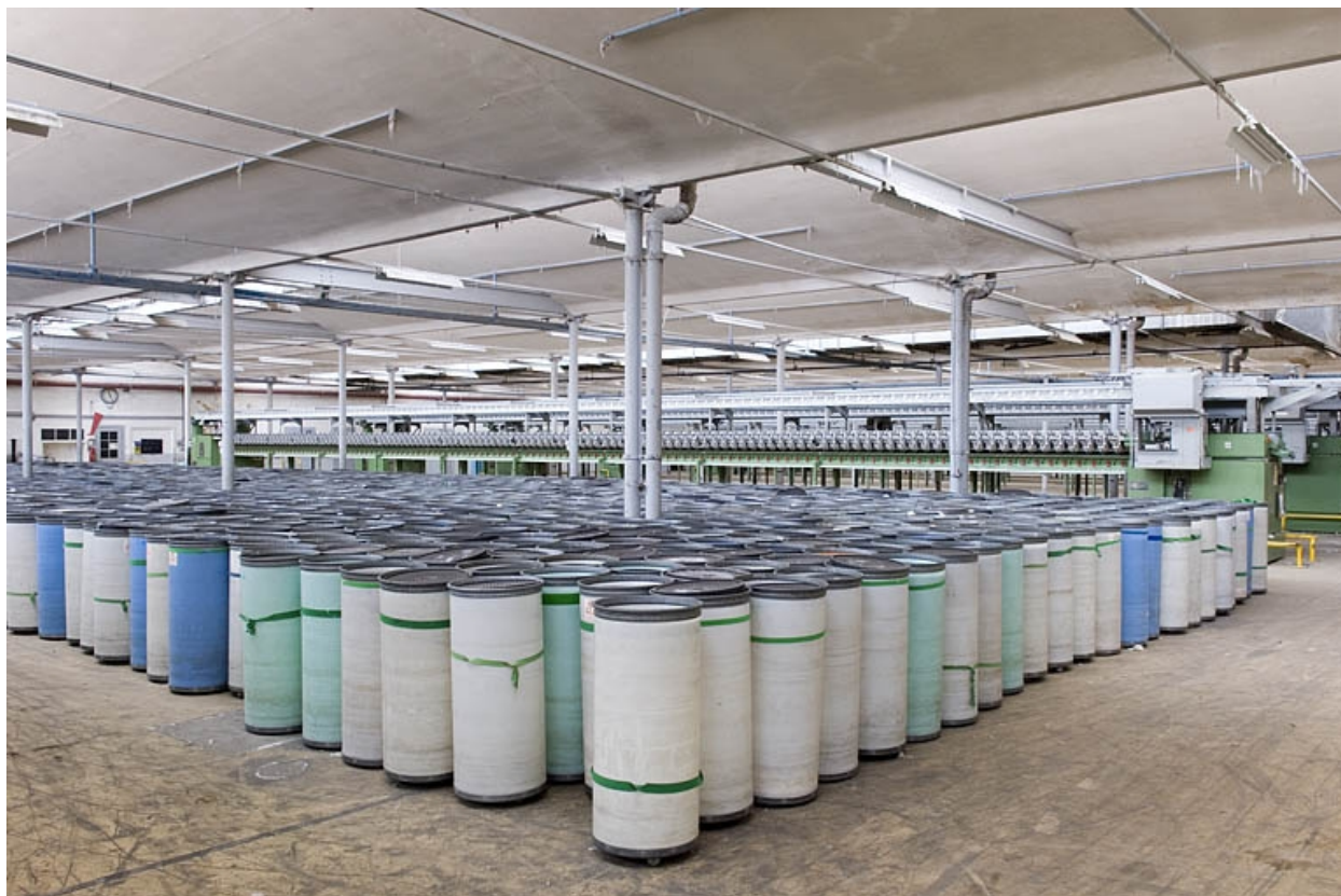
Intérieur d'atelier. Pots de filature et continus à filer.
