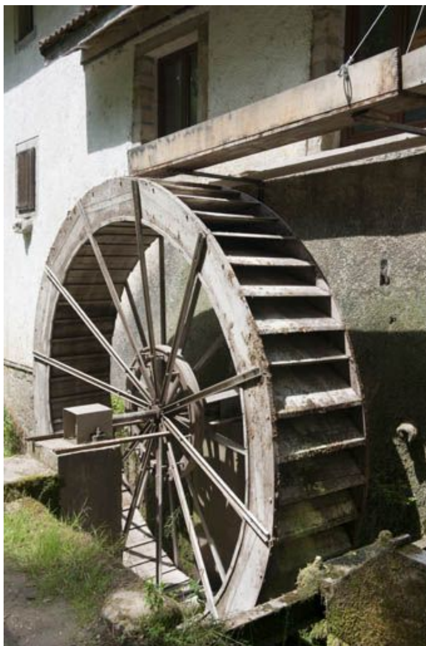
Roue hydraulique et sa huche.
