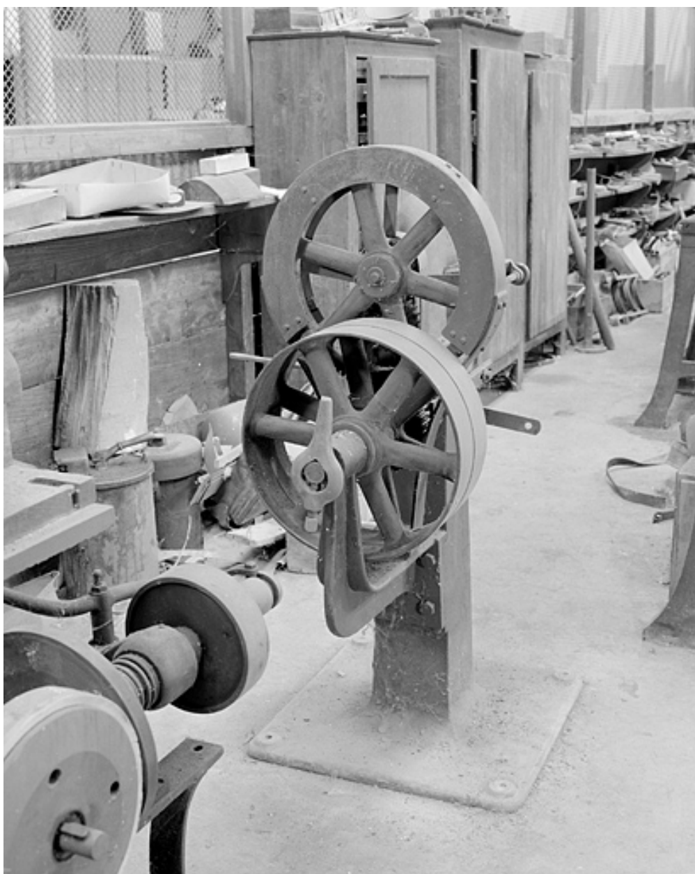
Détail des poulies de transmission.
