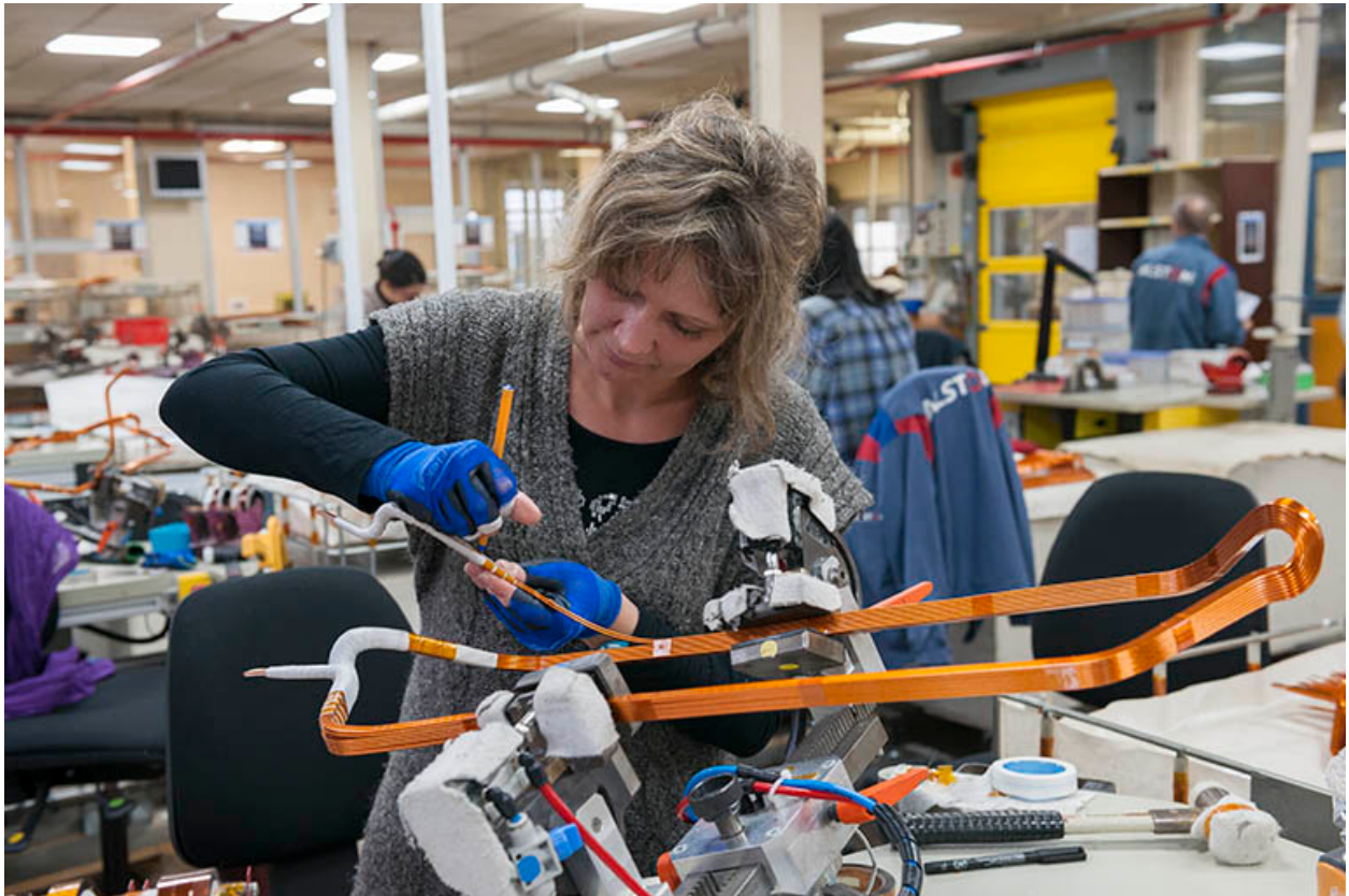
Isolation manuelle des barres de cuivre.
