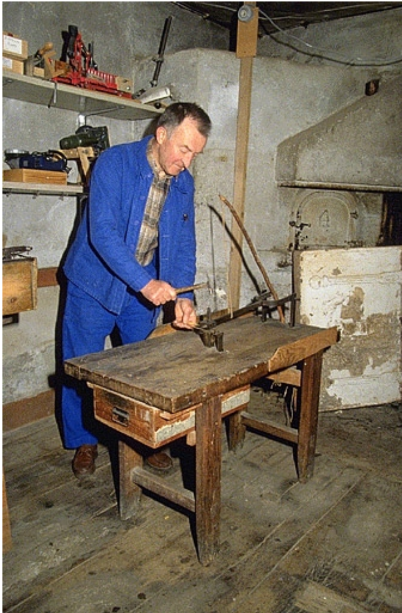
Poinçonnage d'une lame.
