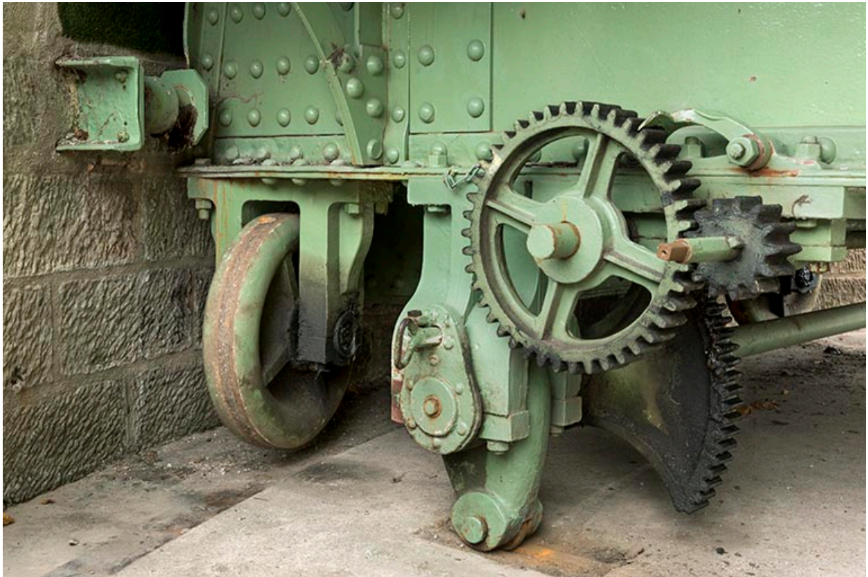
Détail du système de levage.
