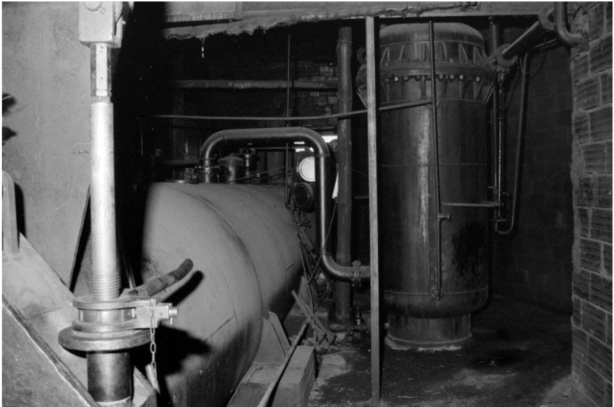
L'autoclave. Autoclave à gauche, cuve de créosote à droite.
