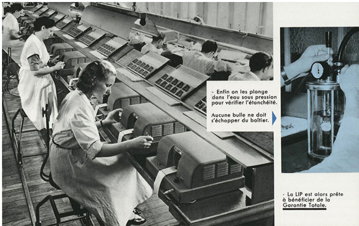
Contrôle d'étanchéité, fotogr., 1956.
